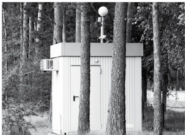
Schutzhaus für Strahlungsmess-Sensoren am Zwischenlager Gorleben (im Bild Messhaus 1 am Haupttor). Die runde Kugel auf dem Dach beherbergt den Sensor für Neutronenstrahlung, weitere Sensoren befinden sich im Inneren.
