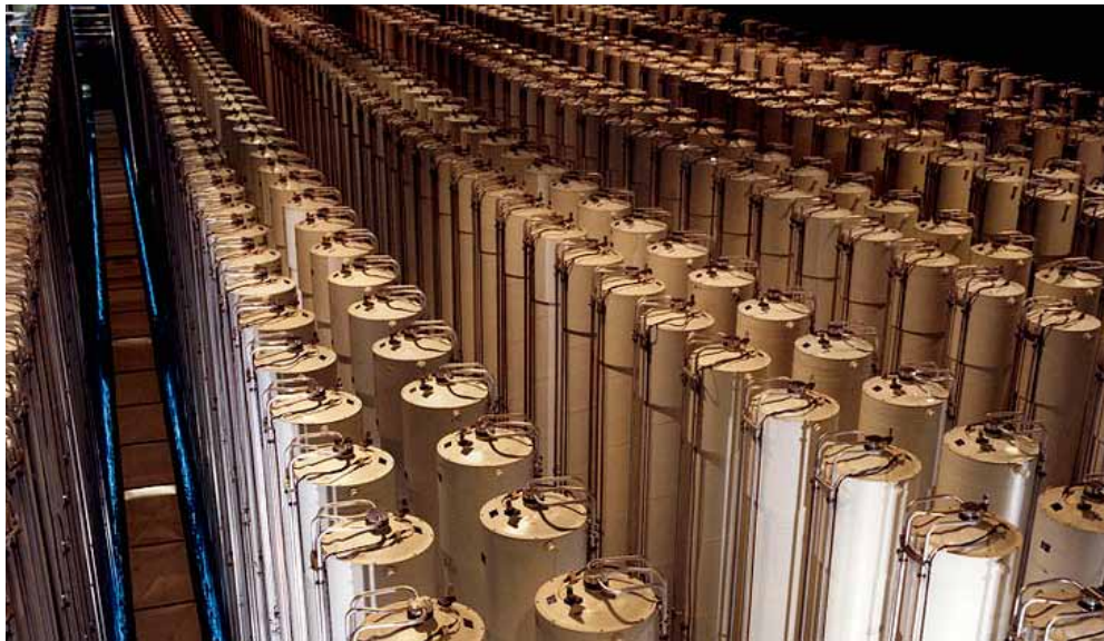
Gaszentrifugenkaskade in der Urananreicherungsanlage in Gronau
